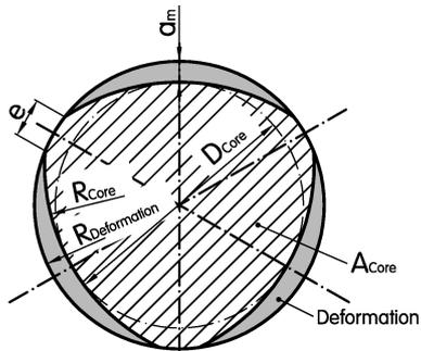
**Abb. 5:** Parameter eines 3-seitig gerippten Stabs mit ovalem Kern ohne Längsrippen.
