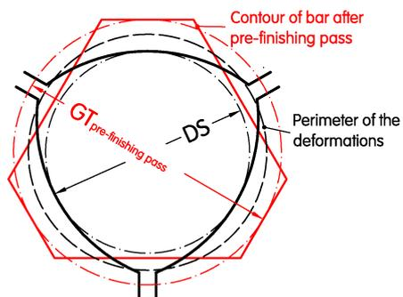
**Abb. 6:** Schematische Darstellung der geometrischen Verhältnisse im Fertigkaliber bei gerippten Stäben mit ovalem Kern.
