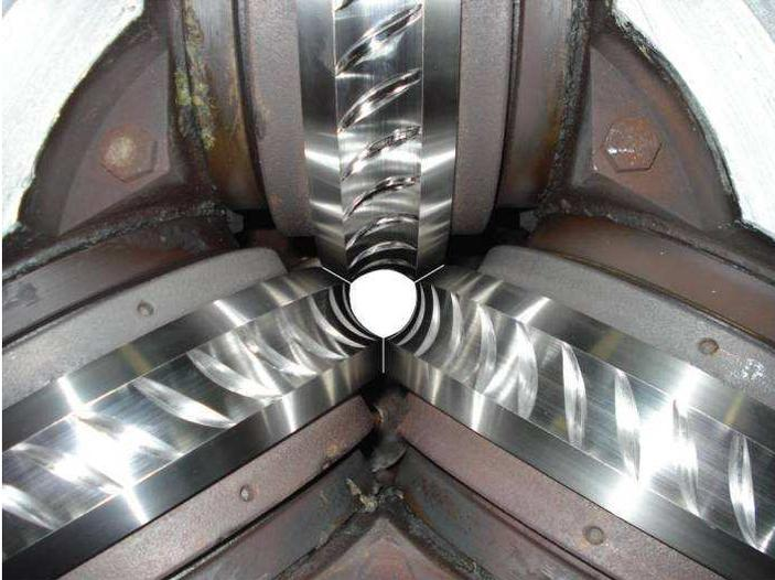
**Abb. 9:** Blick durch das Kaliber der profilierten Walzen.
