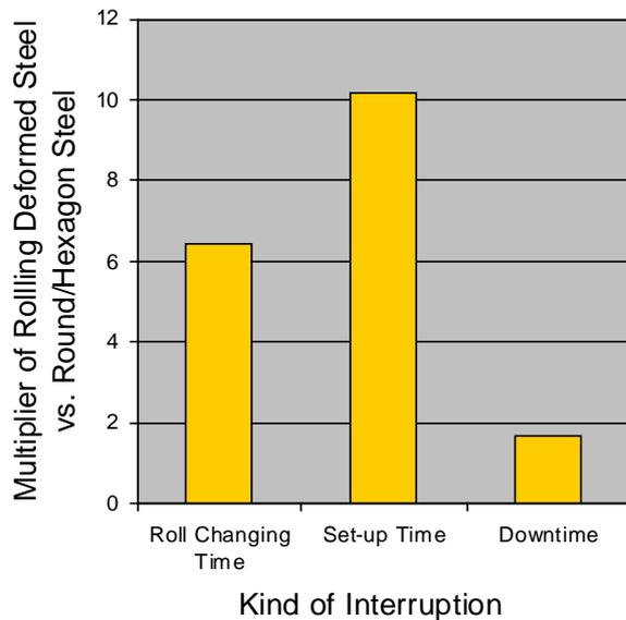
Abb. 3: Umstell- und Störungszeiten für Walzungen von geripptem Stahl im Vergleich zur Rund- oder Sechskantwalzung.
