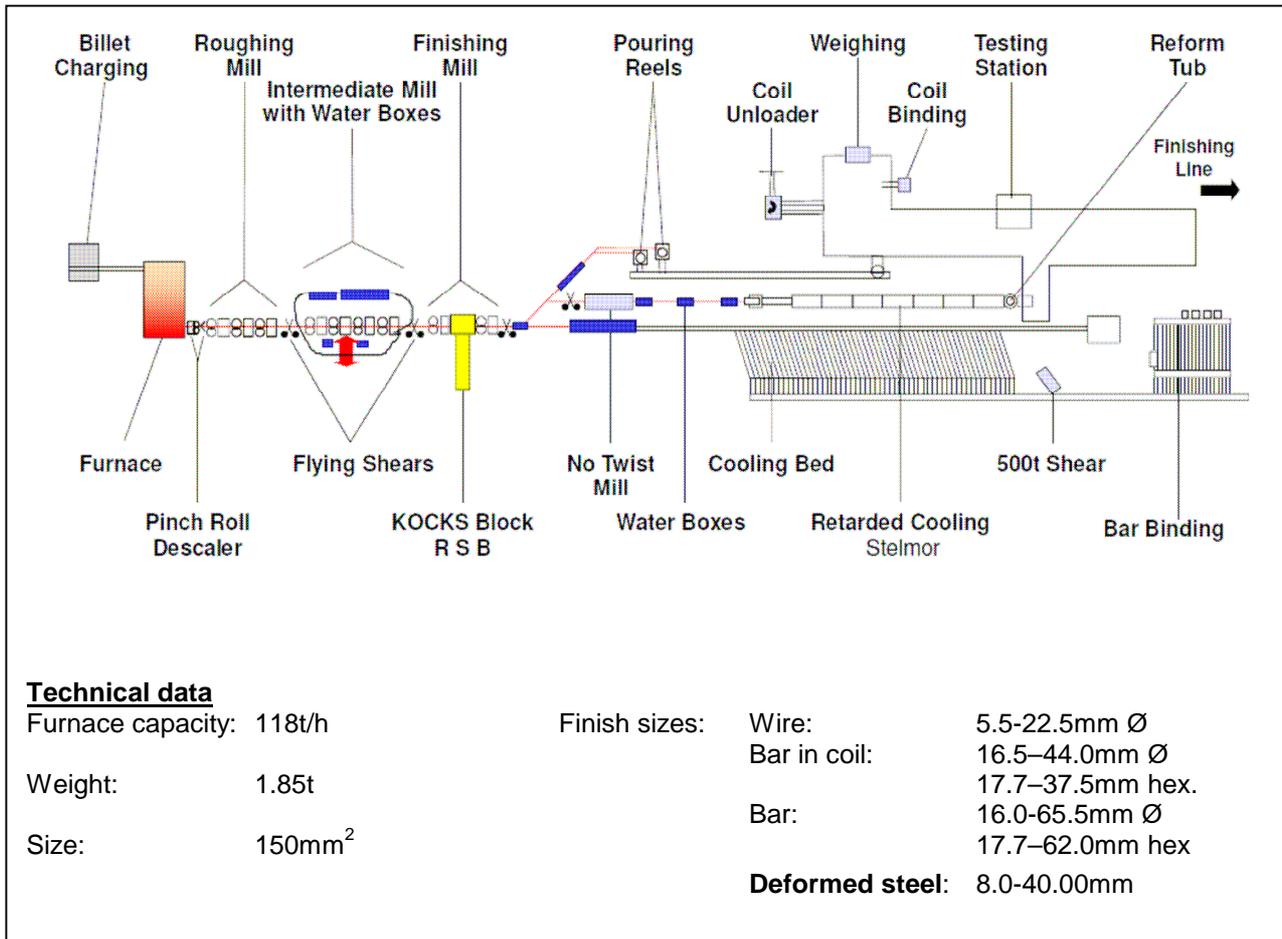
**Abb. 1:** Layout und technische Daten der einadrigen Stab- und Drahtstraße der Swiss Steel AG (SWST AG).
