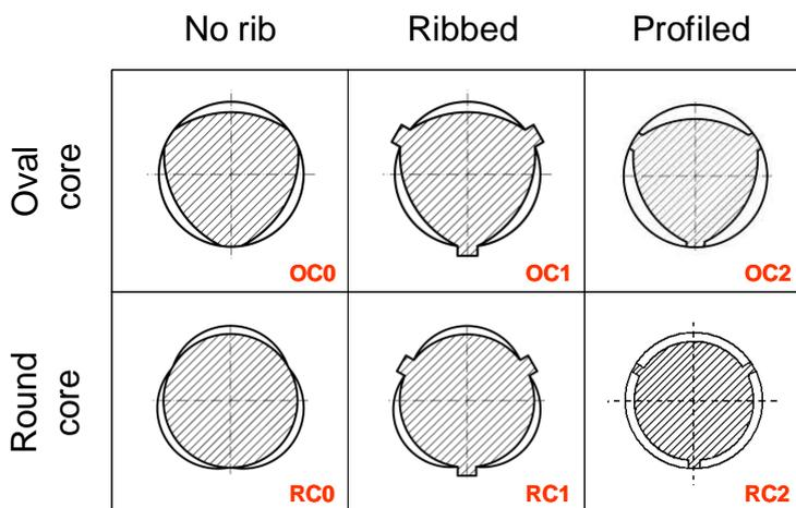
**Abb. 4:** Schematische Darstellung von Basisgeometrien für 3-seitig gerippte Stäbe im Querschnitt mit Kurzbezeichnung bei Kocks.
