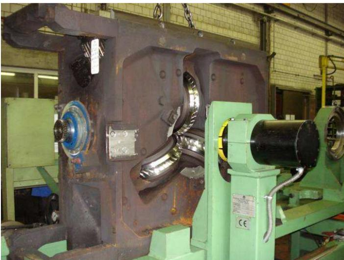
**Abb. 8:** Gerüst des RSBs in der CAPAS-Station von Kocks mit eingebauten profilierten Walzen.
