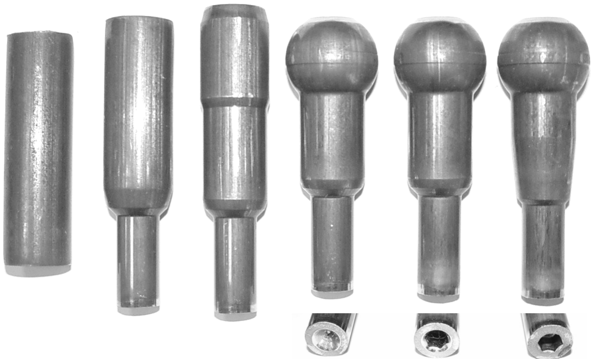
Bild 12 5 stufiger Umformprozess zur Herstellung von Kugelzapfen mit Innensechskant (Abzug 30 %)
